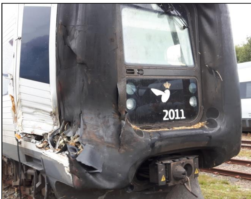
ER 2011 på Tinglev st. efter påkørsel af traktoranhænger i en overkørsel Foto: Torben Rydahl Due
